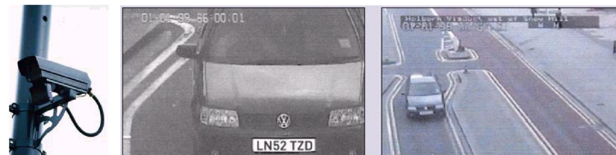
Obr. V.4.2.1-5 Londýn – kamera - zařízení instalované u komunikace a výstupy sloužící pro rozpoznání registračních značek vozidel
